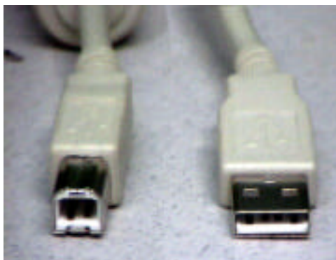
Les deux extrémités d'un câble USB..
